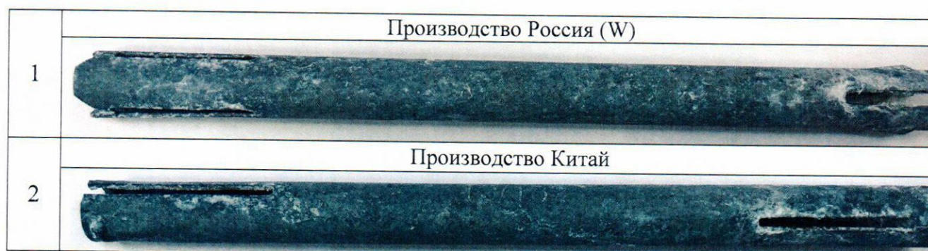
Рис. 3 Внешний вид образцов №1 и №2 после испытаний в камере соляного тумана в течение 500 часов.
