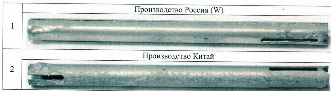
Рис. 2 Внешний вид образцов №1 и №2 после испытаний в камере соляного тумана в течение 150 часов.
